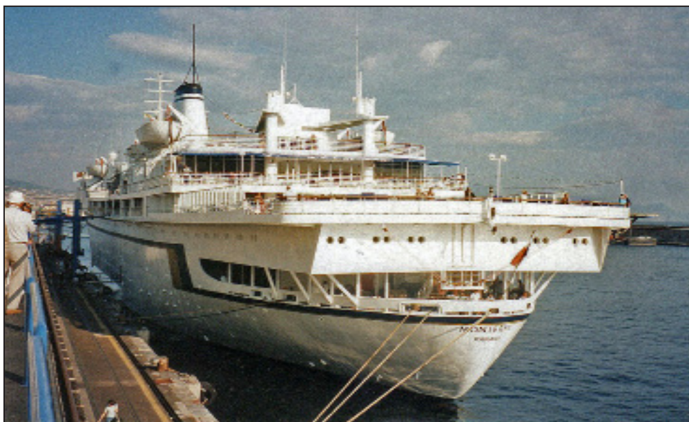
LA ESTRUCTURA DEL LIDO MONTADA SOBRE LA POPA
