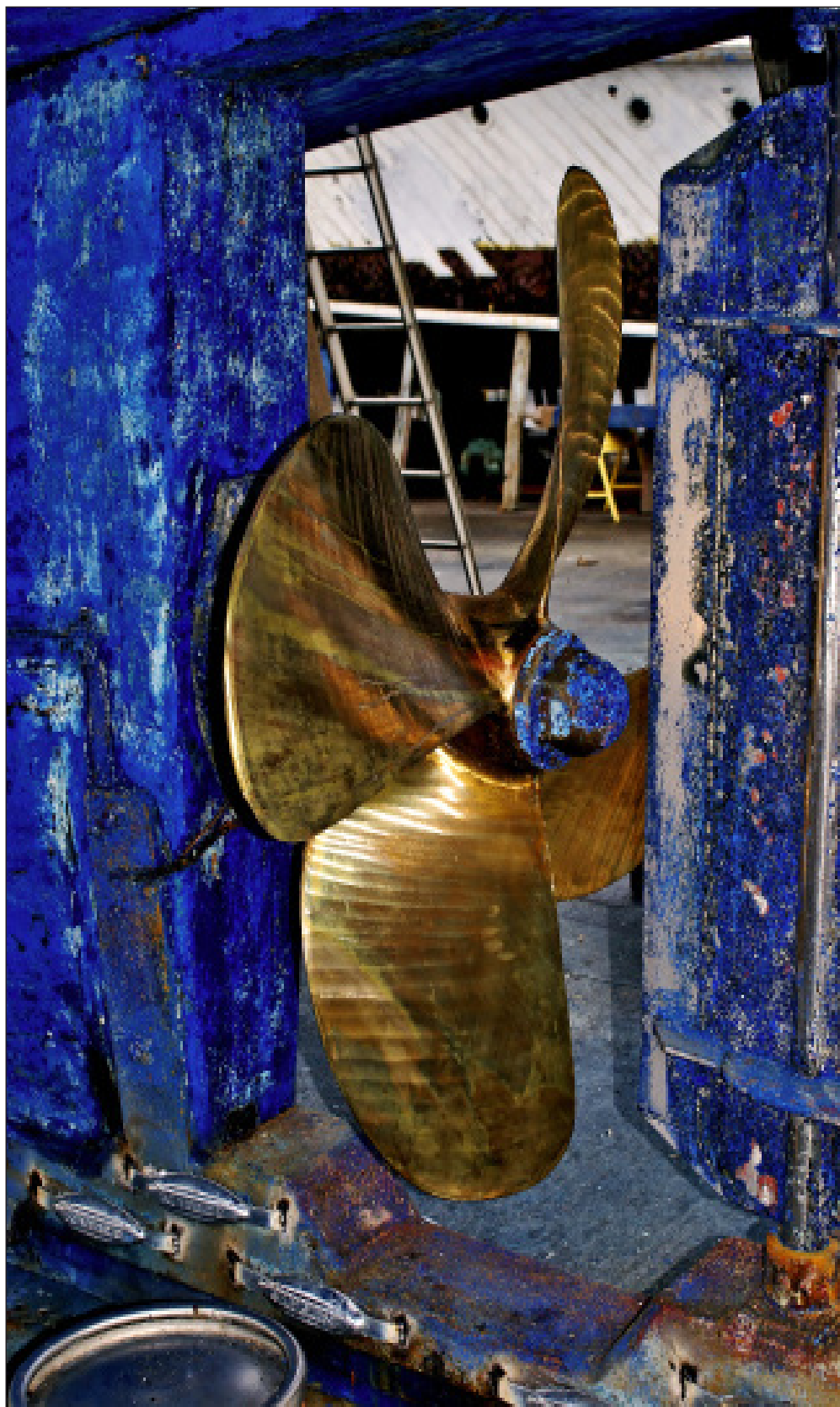
Barco de arrastre Pito Quintana F. en seco. Hélice y timón (Artefoto)
